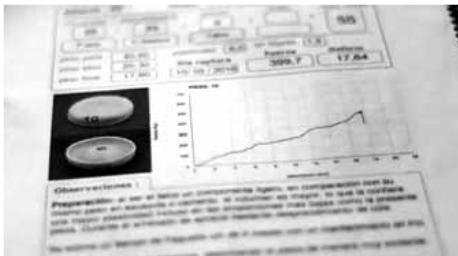
Fig. 8. Hoja de resultados después del ensayo a compresión de una probeta semiesférica. Laboratorio de Calidad de la Construcción del Gobierno de Canarias, 2016
