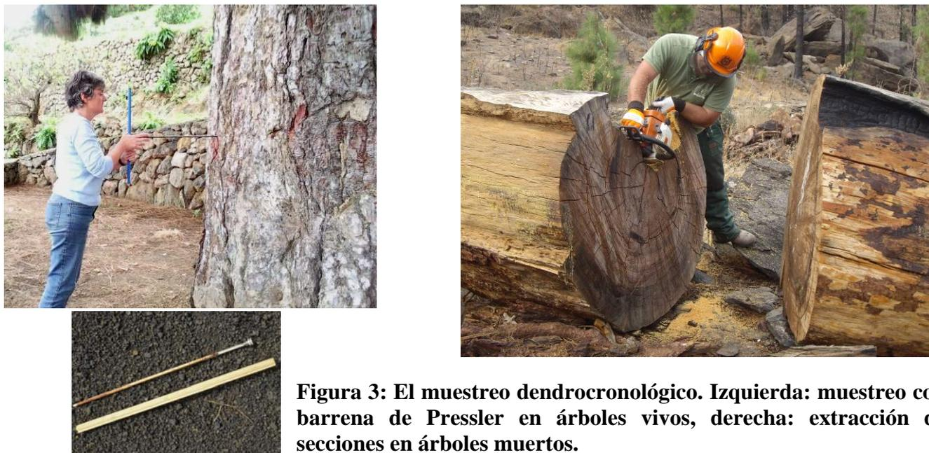
**Figura 3: El muestreo dendrocronológico. Izquierda: muestreo con barrena de Pressler en árboles vivos, derecha: extracción de secciones en árboles muertos.**
