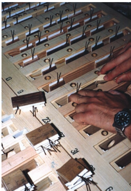
■ Encolado y ajuste de las válvulas de secretos reconstruidas
