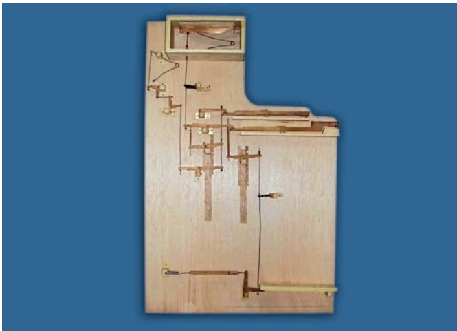
■ Prototipo para el estudio de la tracción de notas y sus acoplamientos desde las teclas hasta el secreto
