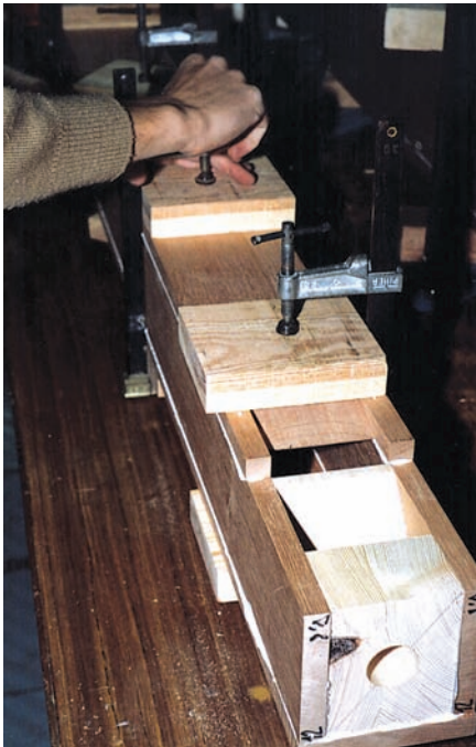
■ Proceso de reconstrucción de un tubo de madera
