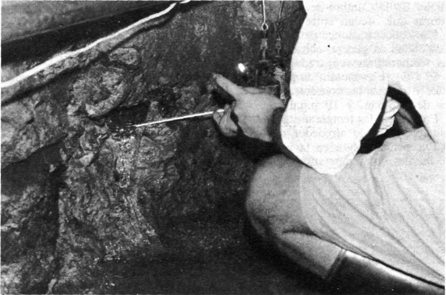
MEDICION DE TEMPERATURA DE MANAÑIALES EN PERFORACIONES HORIZONTALES DE PEQUEÑO DIAMETRO
