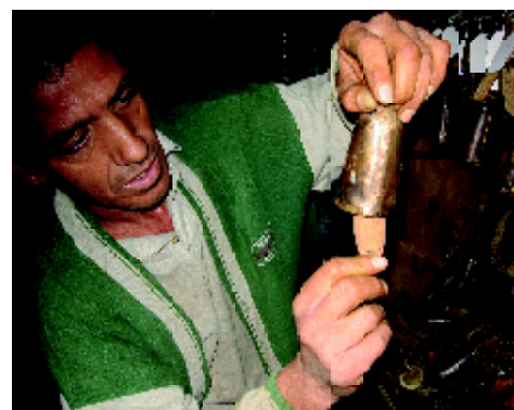
La primera imagen muestra a cómo para el correcto templado se comprueba varias veces el sonido que hace el badajo al golpear en diversas partes del cuerpo de la cencerra. Debajo, una primera prueba del sonido que produce un badajo.
