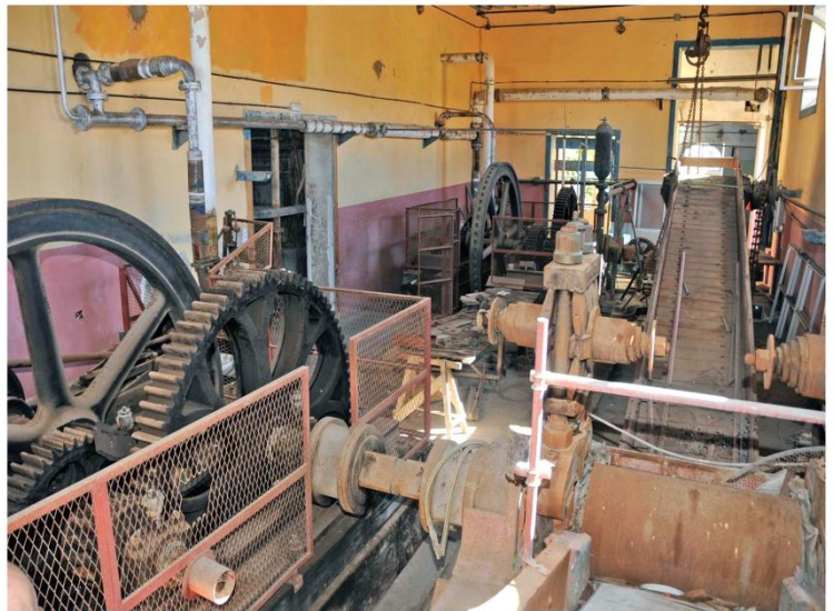
Sala de molturación. Dos molinos, para dos trenes, accionados a vapor, marca The Wirls Waston Yarian ,
