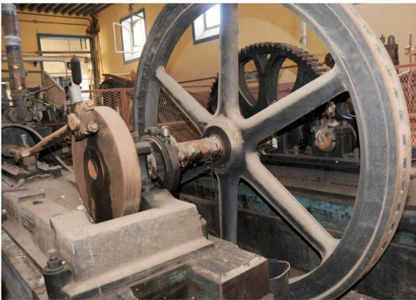
Sala de molturación. Dos molinos, para dos trenes, accionados a vapor, marca The Wirls Waston Yarian ,
