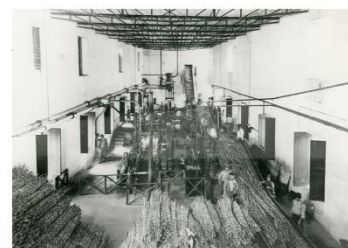
Interior de la fábrica de azúcar de Figueira, en Funchal. Tren de molturación originario de la fábrica de Guía.
