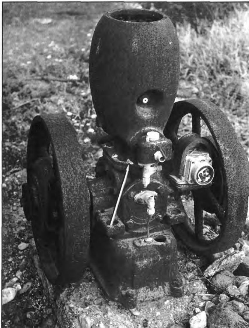
Fig. 5. *Un pequeño motor Petter de 2-3 C.V. de encendido con magneto-bujía y refrigeración por «caldera», instalado en los años 30 por los Hernández en Los Cascajos Altos. La Aldea. Una verdadera joya para la Arqueología Industrial.*
