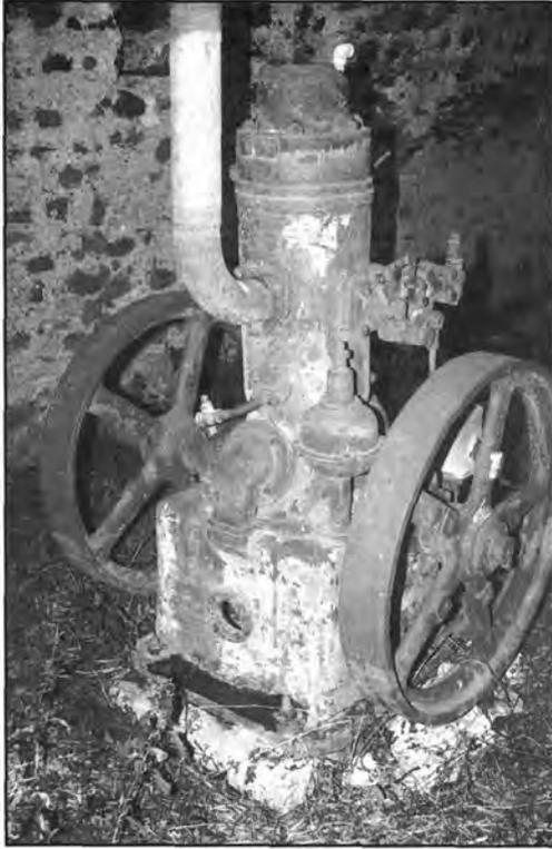
Fig. 4. Motor *Kiel* de la fábrica alemana Neuffeldt-Kuhnke. El motor prediesel antiguo más generalizado en La Aldea.
