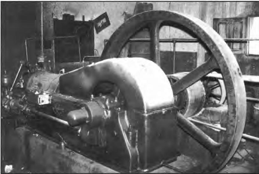
Fig. 16. Motor **Robson**, tipo C.H.R. de 40 C.V. y 290 r.p.m. instalado por Franco Aquel en la Zarcilla (La Aldea). Hasta avanzados los años 50 los motores ingleses **Robson**, **Ruston-Hornsby**, **Blackstone**, al igual que los viejos **National** y **Tangye**, mantenían este mismo diseño: grandes volantes, árbol de levas y mecanismos de engrase arcaicos y externos, etc. De poco rendimiento específico pero de gran resistencia y durabilidad.
