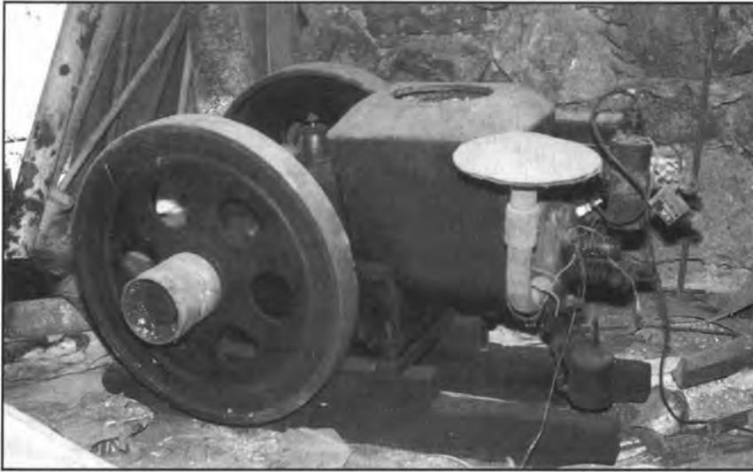
Fig. 8. Motor americano *Stover V.F.Q.* La máquina térmica auxiliar del molino más generalizada en La Aldea en los años 30. Un pequeño motor de encendido con magneto-bujía y refrigeración por caldera o termosifón, de potencia entre los 2 y 3 C.V. Propietario: Miguel Montesdeoca (La Cruz).
