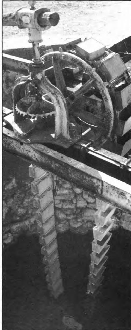
Fig. 1. *Noria de fundición. Las viejas ruedas de madera se sustituyen por malacates de fundición y los arcaduces de barro por cangilones de latón.*
