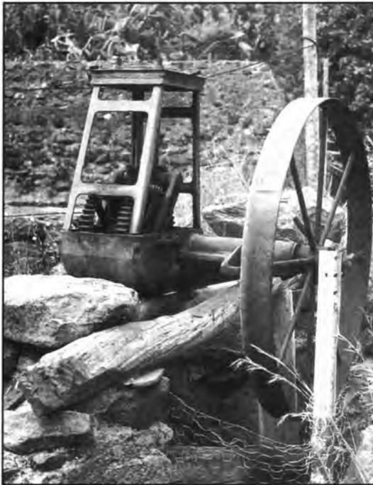
Fig. 14. La genialidad inventiva de muchos agricultores los llevó por necesidades a crear sistemas propios de elevación de aguas acoplados a su pequeño motor, como el que vemos en este pozo de los Oliva en El Hoyo (La Aldea) donde se utiliza como cabezal el sistema de transmisión de un molino americano **Samson**. Hecho este que se repite de una u otras formas por la geografía local y que suele denominarse como generación informal de la tecnología.
