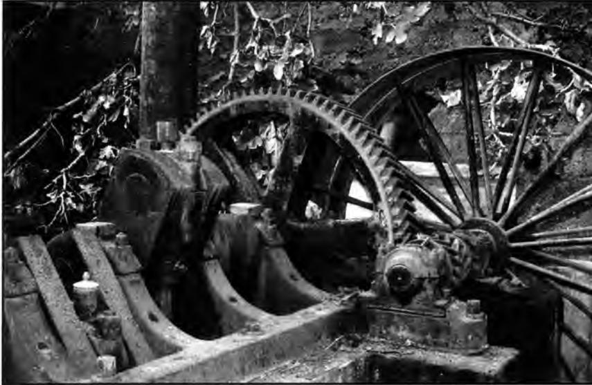
Fig. 2. *Cabezal de bomba de pistón de tres cuerpos fabricado por Enrique Sánchez a finales de los años 50. (Pozo de los Alonso. San Clemente. La Aldea)*
