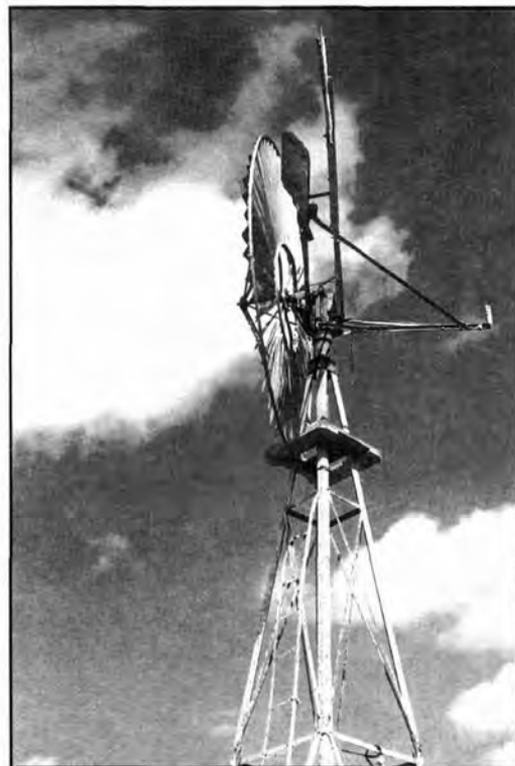
Fig. 1. *Aeromotor construido en talleres locales según los modelos de importación. Transmisión por cigüeñal (Gran Tarajal, Fuerteventura).*
