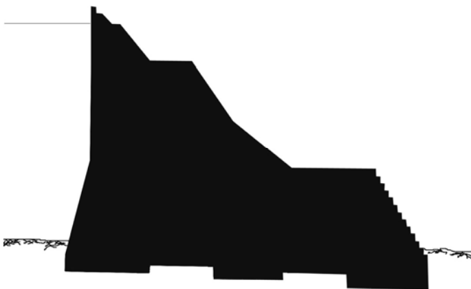
Sección tipo de la presa primitiva de Martínón (Elaboración propia)
