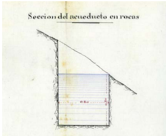
Sección de la acequia en rocas que liga el Túnel de San Lorenzo con el embalse (Fuente Plano de Detalles del Proyecto de 1902)
