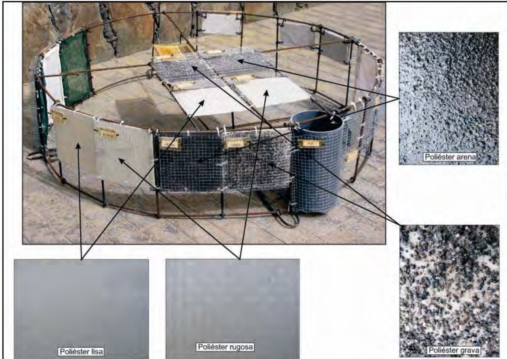
Foto 8.- Descripción de los materiales sobre la estructura fondeada el 12 de Marzo de 2009. (M.A. García Campos, Marzo 2.009).
