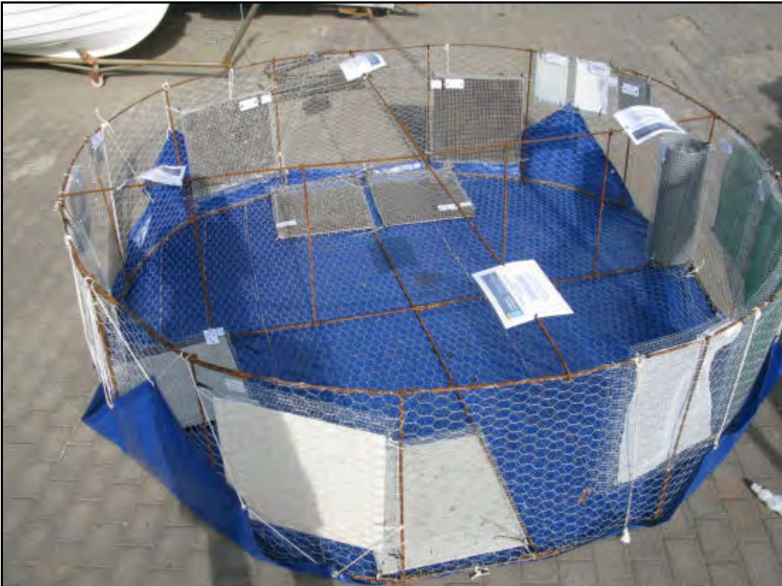
Foto 2.- Conjunto de materiales a muestrear colocados sobre una nasa modificada. Esta estructura pertenece a la primera serie fondeada el 18 de Noviembre de 2008. (M.A. García Campos, Noviembre 2.009)
