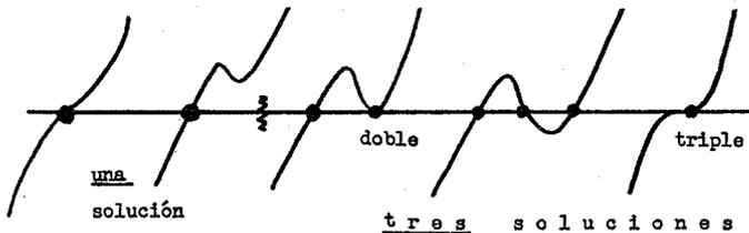
Notemos que de las tres raíces del polinomio cúbico, supuesto que existan, una es posible que sea doble y distinta de la tercera, digamos  $x_1 \neq x_2 = x_3$ . Entonces,  $f(x) = (x-x_1) \cdot c(x)$  con  $c(x) = a(x-x_2)^2$  y  $x_2$  estará situada en el vértice de  $y=c(x)$ .
