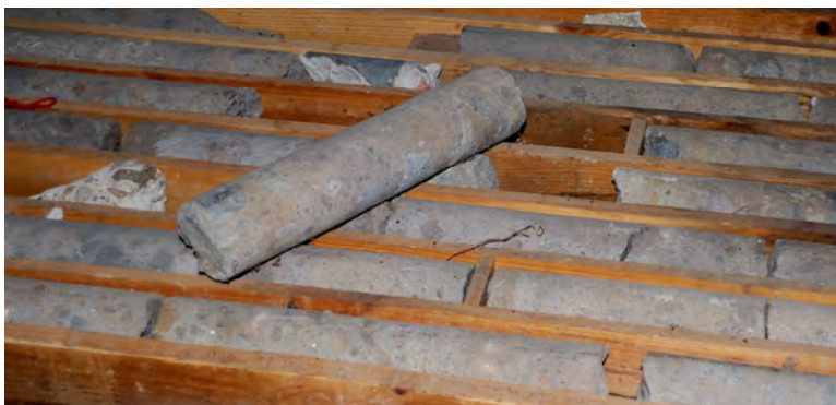
Detalle de los testigos de los sondeos de 1972 (Fotos Jaime González)
