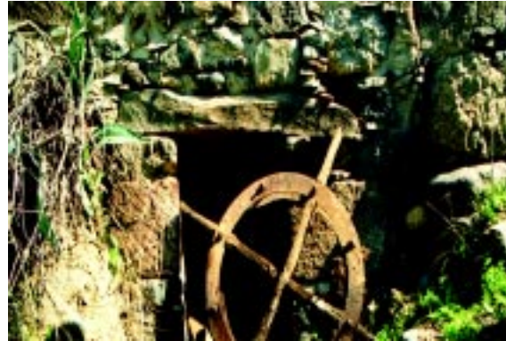
De izquierda a derecha, riego y cubo del primer molino del riego de La Zarcilla, y crucero de madera y anillas de acero de un antiguo rodezno.
