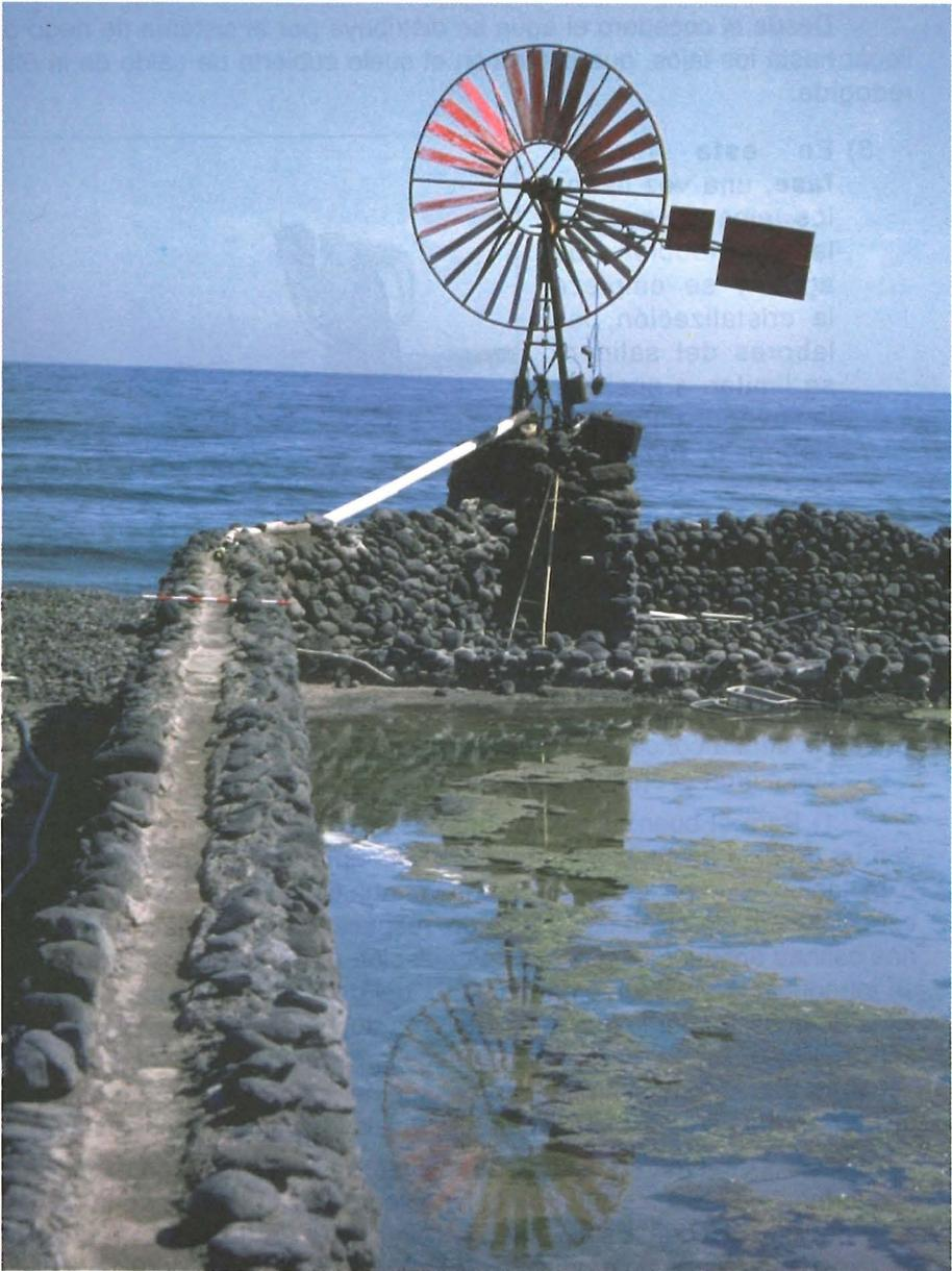
**Figura 11:** Sistema de bombeo (molino).
