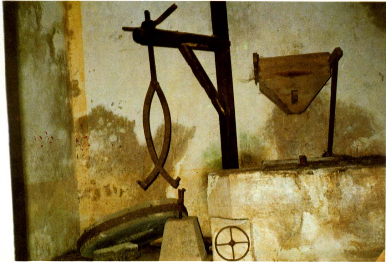
Cuenca del Barranco de la Virgen: "Molino Chico". Tolva y pescante.
