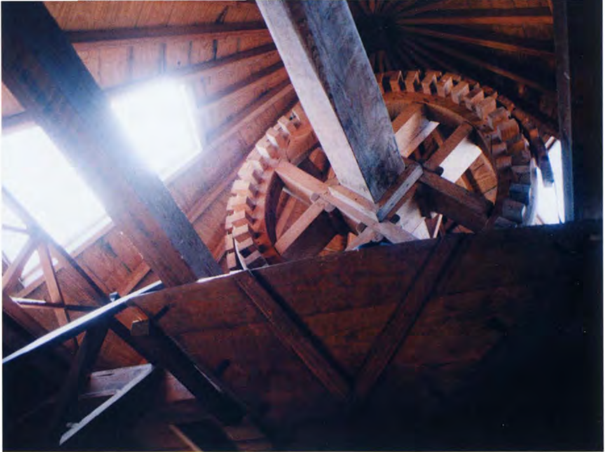
Engranajes y tolsa de un molino de gofío en el museo agrícola El Pinar
