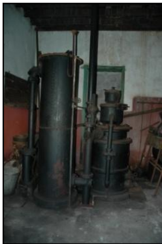
SALA DE MAQUINAS DEL POZO DEL PINO (ARUCAS). A LA IZQUIERDA LAS CALDERAS DE PRODUCCIÓN DE GAS POBRE Y A LA DERECHA LOS DOS MOTORES GEMELOS, TANGYE , PERO DE DISTINTA COMBUSTIÓN INTERNA (FOTG. FCO. SUÁREZ)
