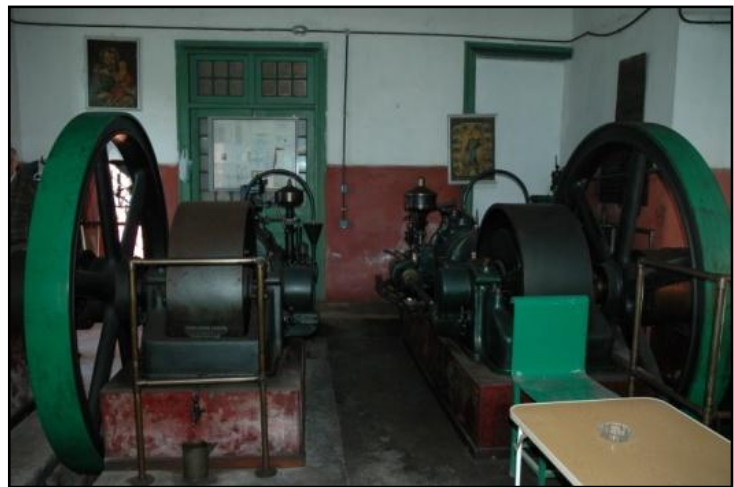
SALA DE MAQUINAS DEL POZO DEL PINO (ARUCAS). A LA IZQUIERDA LAS CALDERAS DE PRODUCCIÓN DE GAS POBRE Y A LA DERECHA LOS DOS MOTORES GEMELOS, TANGYE , PERO DE DISTINTA COMBUSTIÓN INTERNA (FOTG. FCO. SUÁREZ)
