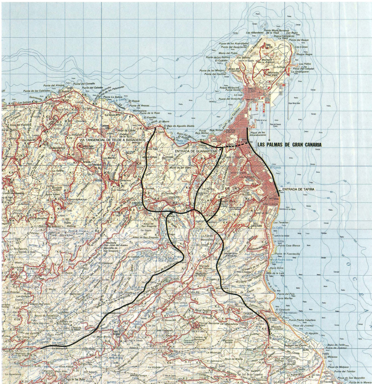
PROPUESTA DE TRAZADO DE LA NUEVA CARRETERA DE ENTRADA A LAS PALMAS DESDE TEJEDA POR EL DRAGONAL
