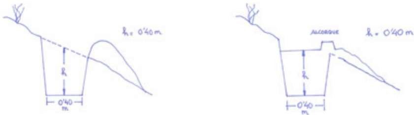
Figura 9.2: Alzado de hoyo y de tapado de hoyo con poceta para repoblación.
