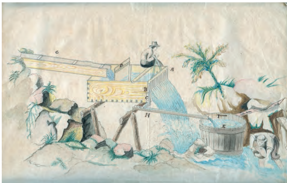
Canalización de madera con explicación de sus elementos. Dibujo del siglo XIX. Hereditario de aguas de La Orotava. AHPT
