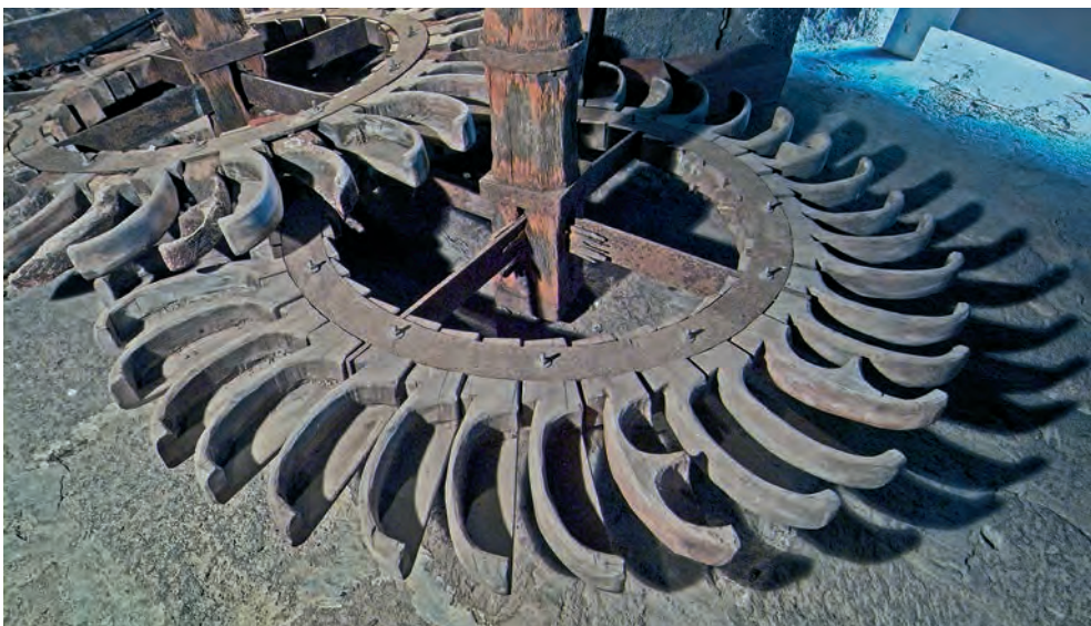
Rodeznos de madera. Molino de Lercaro. La Orotava
