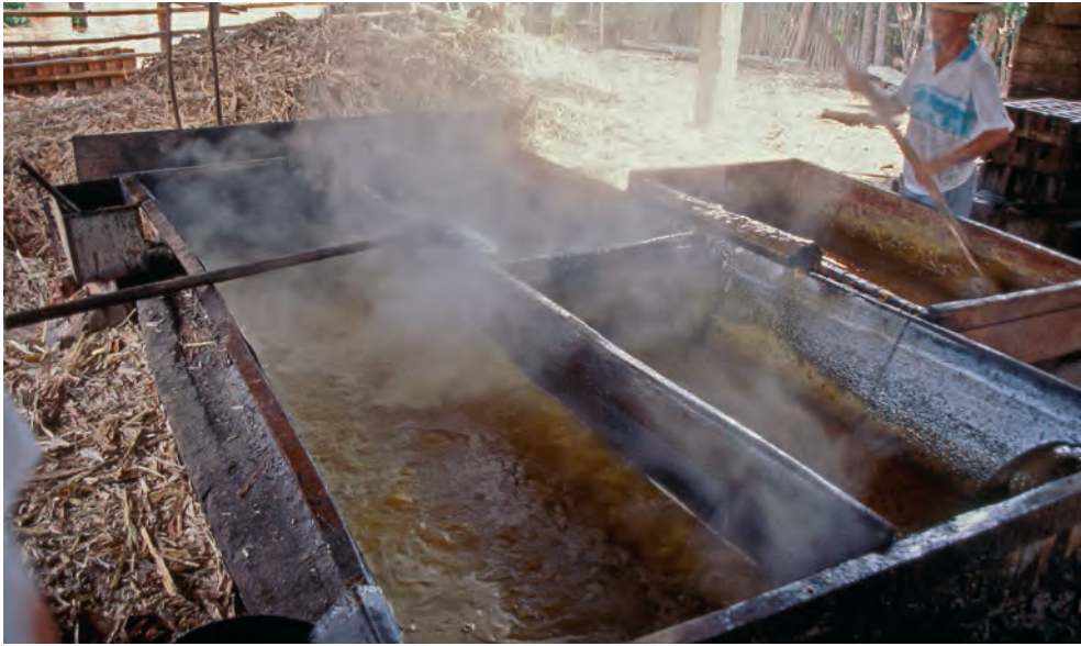
Cocción del caldo en artesas de madera. Trapiche en Vilcabamba. Ecuador
