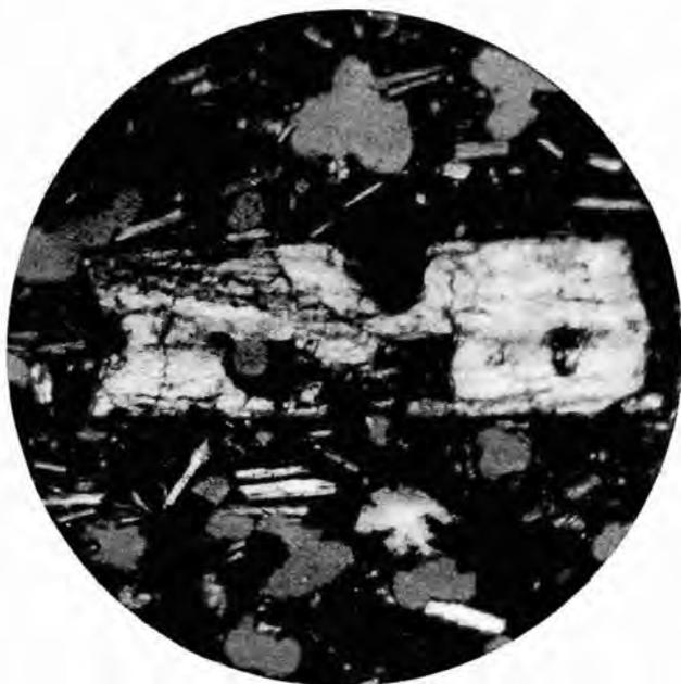
Fig. 53.—Luz polarizada. Nicoles a  $70^{\circ} \times 60$  diámetros. Fenocrystal de augita en una pasta de microlitos de feldespato, augita y vidrio. Las vacuolas, irregulares, aparecen en gris claro, uniforme. Un poro circular atraviesa una inclusión de pasta (negro) en la augita.
