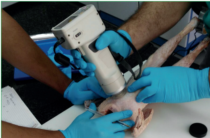
Figura 4.9. Medición del color en pechuga / Figure 4.9. Measurement of chicken breast color. (ICIA)
