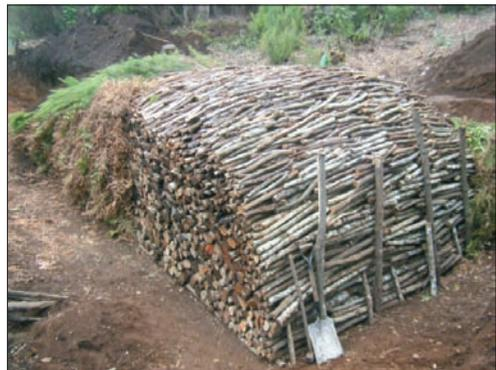
(Foto 7) Actualmente se utilizan planchas metálicas para cerrar la circunferencia de la base de la horna. Posteriormente el control del proceso de carbonización consistía en encender la leña (parte inferior) con jachos de tea encendidos o brasas de la misma madera.
