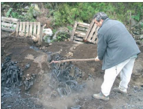
(Foto 10) El material obtenido es muy combustible, solidó, frágil y poroso con alto contenido en carbono. Se produce por calentamiento de la madera a altas temperaturas que oscilan entre 400 y 700 C, en ausencia de aire. El poder calorífico del carbón vegetal oscila entre 29000 y 35000 kj/kg, y es muy superior al de la madera, que oscila entre 12000 y 21000 kj/kg.»<sup>5</sup>.
