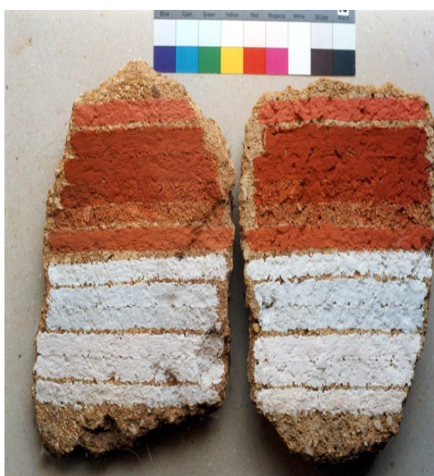
Fig.12 PLACAS DE VERIFICACIÓN n°2 y 3 Comparación de las dos placas tras la exposición en el exterior de la placa durante 18 meses (en la imagen corresponde la placa 3 a la situada a la derecha). Podemos apreciar también diferentes grados de dilución aplicados con el color rojo
