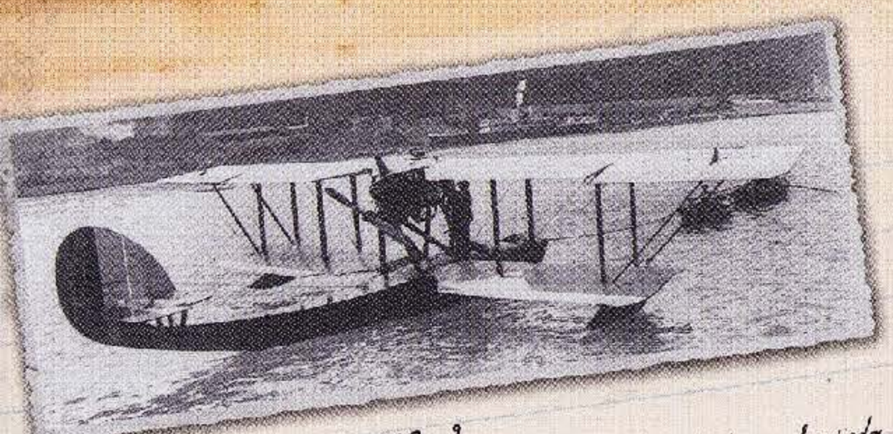
24-12-1919. Ganga-Lay HB-2 Biplano hidroaerona monomotor y biplaza de origen francés que, pilotado por el aviador de la Marina francesa Henri Lefanec y su mecánico Raoul, fue el primero que llegó a Canarias por sus propias méritos. Partió con motor Renault 12 F de 350CV que le proporcionaba una velocidad máxima de 145 km/h. El día 24 de diciembre de 1919 aterizó en el Puerto de La Luz (Las Palmas). El día 13 de enero de 1920 partió de esta isla amarrado en las aguas de la playa de El Reducto de Anzeife de Lanzarote para continuar posteriormente hacia Dakar, en la costa africana, con objeto de estudiar la implantación de una línea aérea en África occidental.
