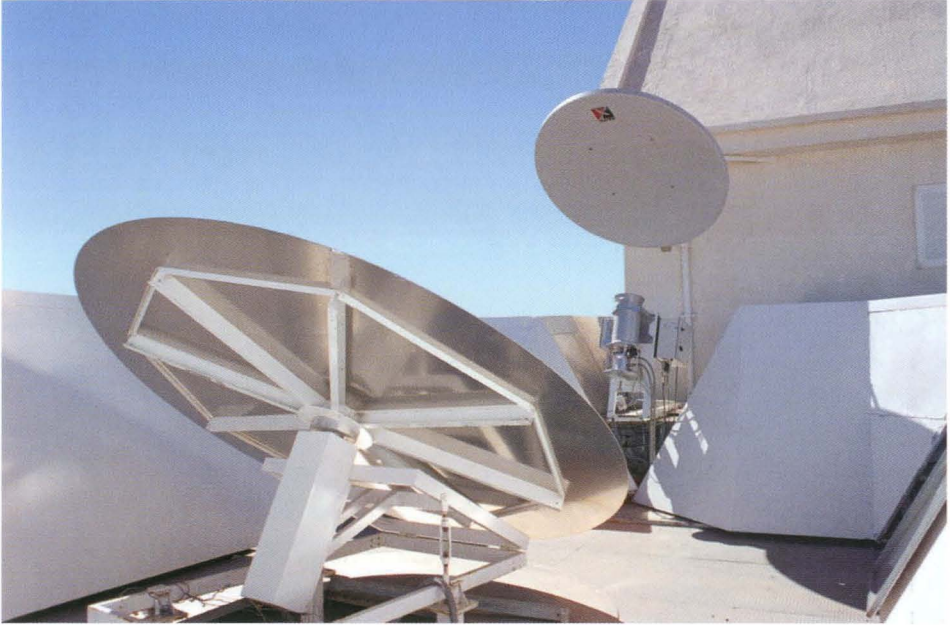
Fig. 6. Uno de los experimentos del proyecto COSMOSOMAS. El plato circular refleja la radiación en la antena que a su vez la focaliza en el receptor enfriado criogénicamente.
