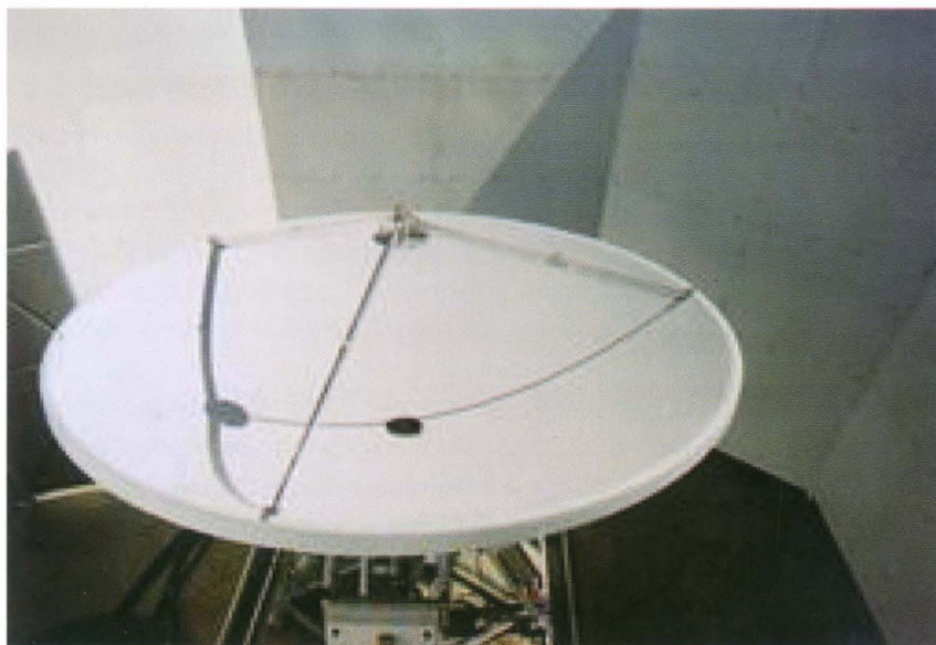
Fig. 11. Una de las dos antenas de 3.7 m de diámetro que conforman el interferómetro corrector de emisión de radiogalaxias del experimento Very Small Array.
