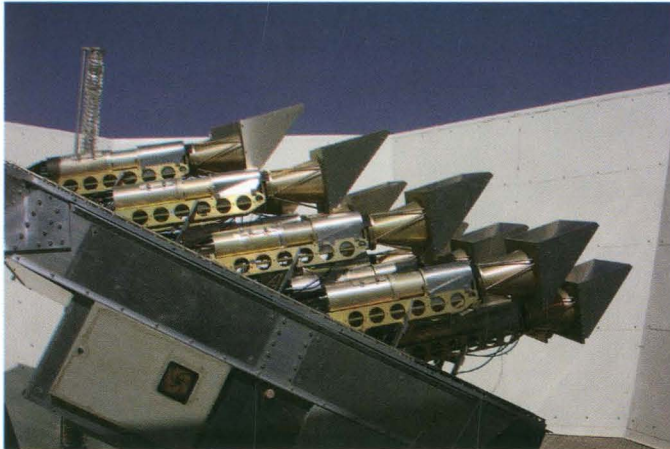
Fig. 10. El conjunto principal de antenas del Very Small Array en su emplazamiento del Observatorio del Teide. Podemos ver la configuración extendida.
