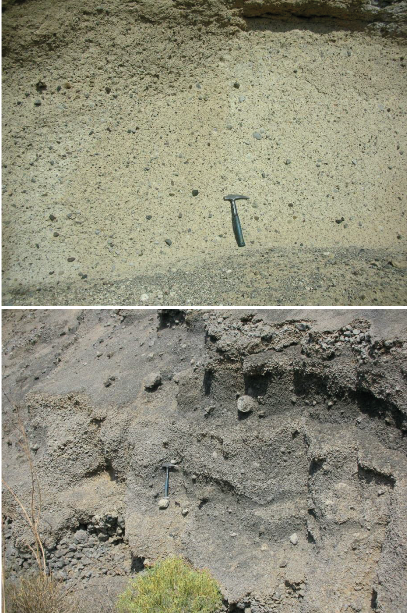
Figura 1-b. Litotipos volcánicos más representativos de Canarias. Arriba: ignimbrita no soldada (IG-NS) o "tosca". Abajo: piroclasto basáltico suelto (LPS) o "picón". Fotos: EurGeol Roberto Poncela.
