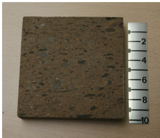
Figura 17. Muestra de mano de ignimbrita soldada (IGS).
