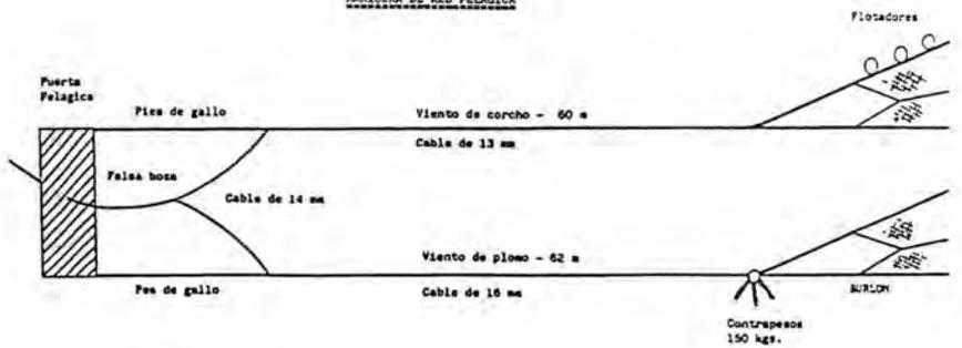
Fig.: 2.2. Arte de arrastre pelágico utilizado en la prospección hidroacústica.
