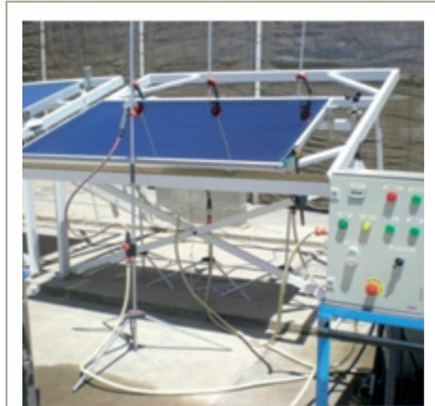
Figura 22.6. Ensayo de choque térmico externo (Laboratorio LABSOL/ITC)
