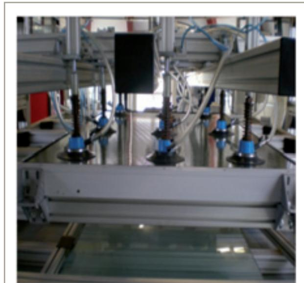
Figura 22.7. Ensayo de carga mecánica positiva (Laboratorio LABSOL/ITC)
