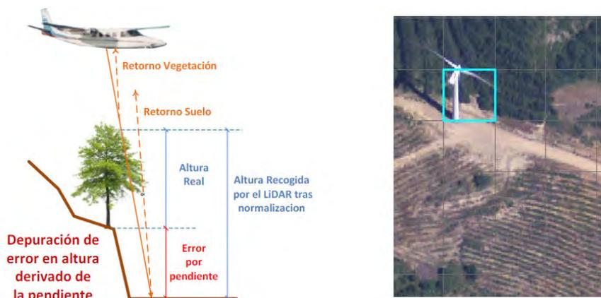
**Figura 4** Ejemplo de error por pendiente (izquierda) y por presencia de aerogeneradores localizados en celdas de terreno agroforestal (derecha)
