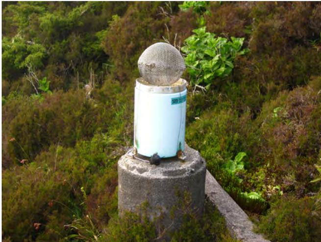
Imagen 2. Medidor de precipitación horizontal en Terceira (Azores)
