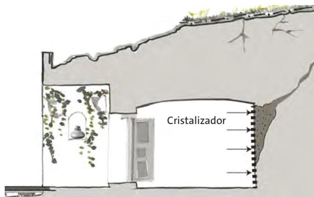
Esquema con aplicación de producto cristalizador (traspirable) para agua presente en paredes de cueva.
