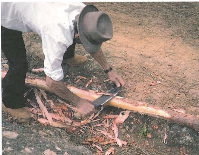
Limpeza o descortezado para el tostado posterior del timón
