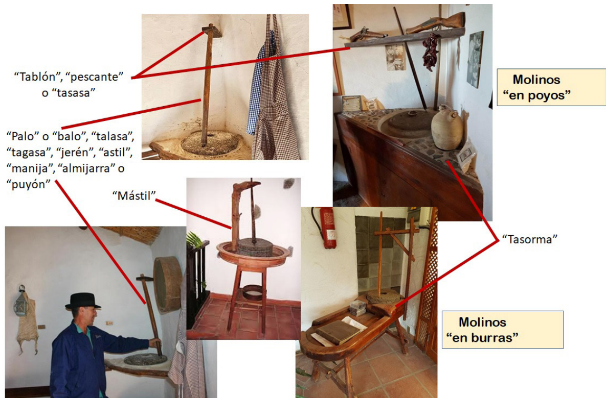
Figura 8. Tipos de molinos de mano y partes (II). Elaboración propia a partir de fotos de Ramón Hdez. y otras dos recuperadas de: https://fuerteventuraenimagenes.com/el-molino-de-mano/ y de: http://www.ecomuseoitinerante.com/catalogo/cata_galeria_zoom.php?soporte=19&id=47&camino=&tema=63
