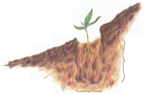
Gráfico 9. En zonas susceptibles de erosión conviene hacer una poceta alrededor de cada árbol. Las pocetas neutralizan la erosión y sirven de cuencas de recepción de agua.
