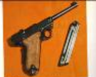
P-08. Desarrollada por Georg Luger sobre el modelo de Hugo Bochart. Tuvo problemas de alimentación. El cierre articulado es delicado. El sistema de disparo es inseguro.
