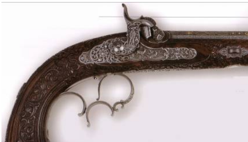
Pistola de duelo, de una pareja, 1.855, Alemania, de J. Adam II Kuchenreuter. Detrás de la cola del gatillo vemos el tornillo para el ajuste del disparo de pelo 20 algo no usual en armas de duelo. (II)
