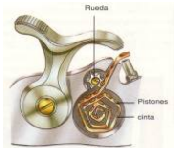
Arma de percusión con la cinta de pistones de Maynard. (16)
