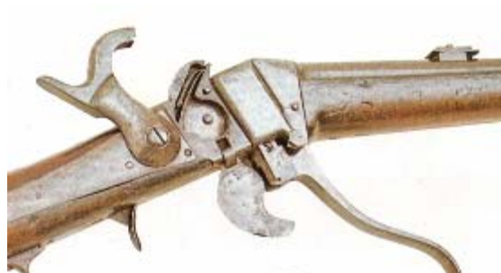
Carabina Sharps, de retrocarga con este modo de ignición, patentada por Christian Sharps en 1.848. (16)
