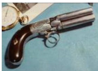
Pistola de 4 cañones rotativos, percusión a pistón, construida por Mariette, primera mitad s. XIX. (3).
