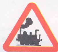
Paso a nivel sin barreras
