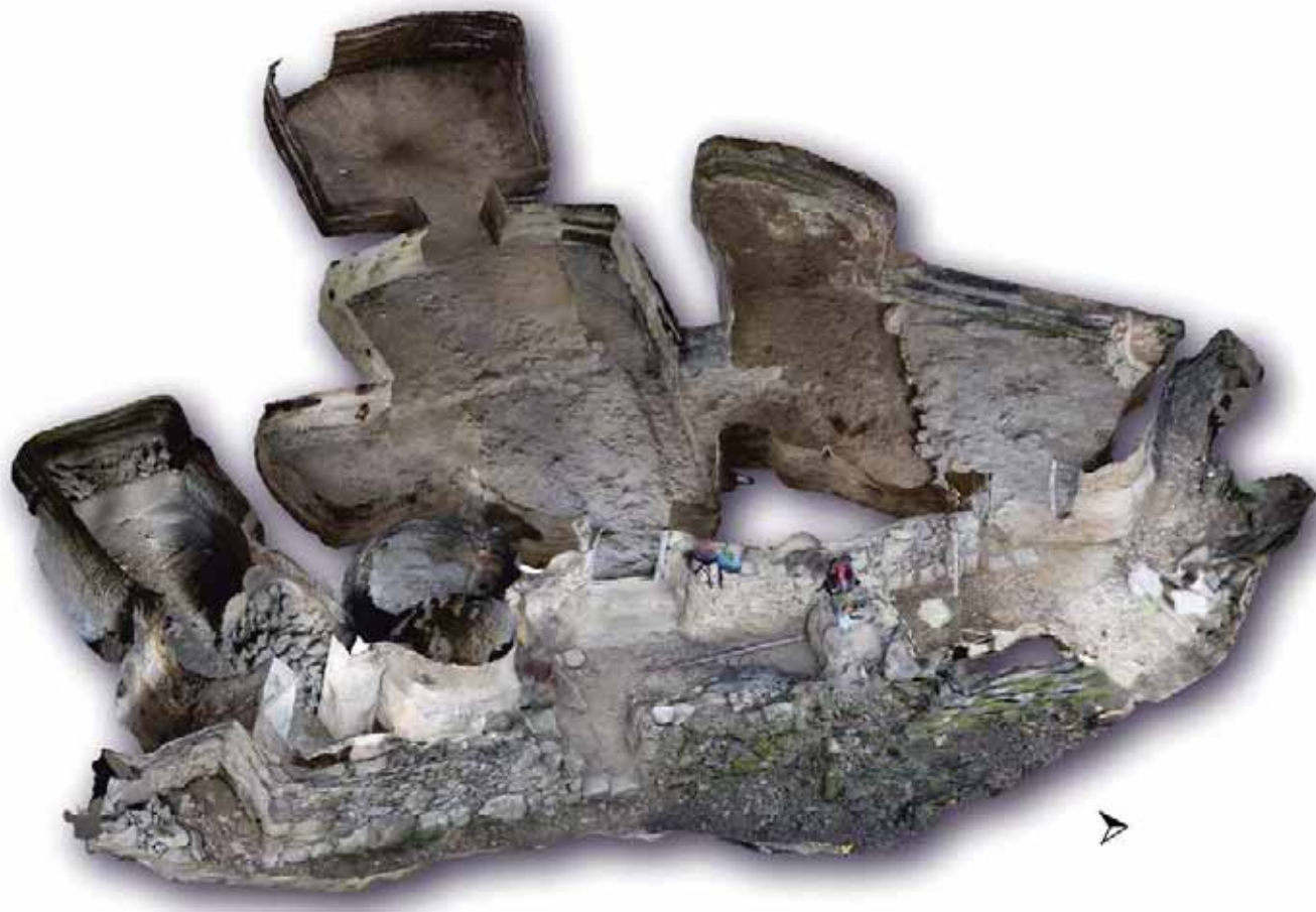
Figura 2.a.49. Levantamiento fotogramétrico de la Cueva de La Paja, próxima a Risco Caído en las laderas de Barranco Hondo, Nube de puntos y vista 3D de la planta general donde se aprecia la distribución de este complejo de cuevas artificiales que albergan una importante colección de grabados púbcos. © Carlos J. Gil Sarmiento
