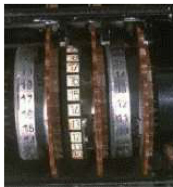
Figura 2b. Ampliación de los rotores de codificación.
