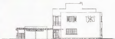
44,5 x 34,5 cm. Fotocopia papel heliográfico. Tinta. Fachada poniente, fachada naciente. La casa se compone incluyendo una pérgola de madera y en "L" entre el garage y el porche. 44.5 x 34.5 cm. Photocopy on heliographic paper. Ink. West facade. East facade. The composition of the house includes a wooden, L-shaped pergola between the garage and the porch.
