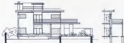
37 x 33 cm. Papel croquis. Graftito y lápiz de color rojo. Perspectiva. La segunda solución desarrolla parte de la terraza con traza semicircular y la salida a la cubierta se cubre con una plancha rectangular. 37 x 33 cm. Tracing paper. Graphite and red pencil. Perspective. The second design develops part of the terrace with semi-circular lines and the exit to the roof is covered with a rectangular slab.
