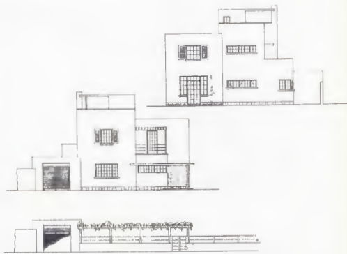
44,5 x 34,5 cm. Fotocopia papel heliográfico. Tinta. Fachada norte, fachada sur. Destaca el hueco horizontal del baño. 44.5 x 34.5 cm. Photocopy on heliographic paper. Ink. North and south facades. Note the horizontal recess of the bath.
