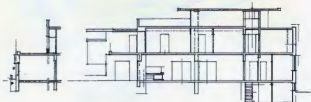
38 x 32 cm. Papel tela. Tinta. Secciones Casa Bonny. En la sección longitudinal destaca el volumen en voladizo de la meseta de la escalera, así como su hueco de iluminación rebajado. 38 x 32 cm. Linen paper. Ink. Bonny House sections. In the longitudinal section note the overhang of the staircase slab and the sunken light well.
