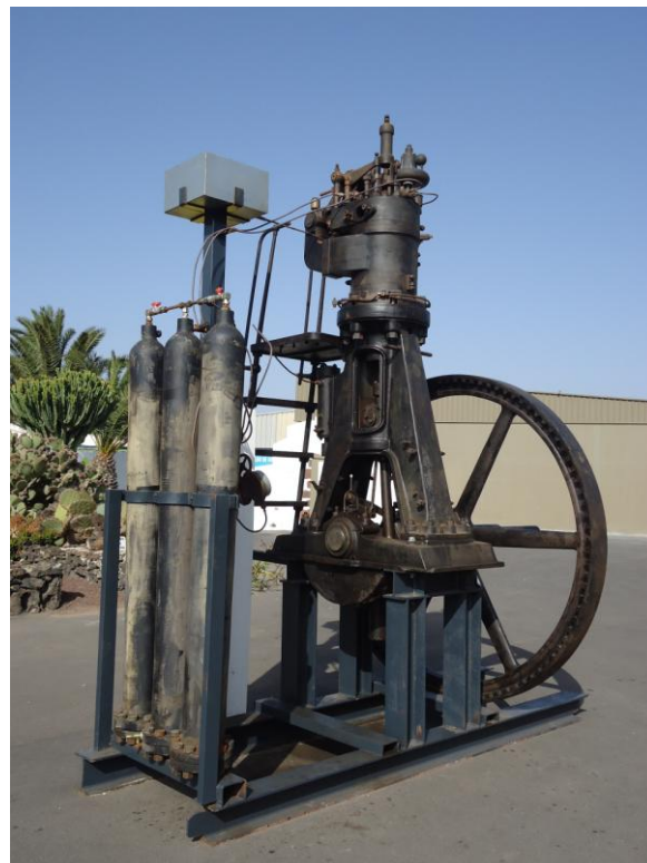
FOTO 5. Motor Lico. Motor de aire comprimido, con un pistón vertical y una bomba de engrase, adaptado y rediseñado para mecanizar una antigua tahona en La Corte (Antigua), propiedad de José Lavandera Vega.
