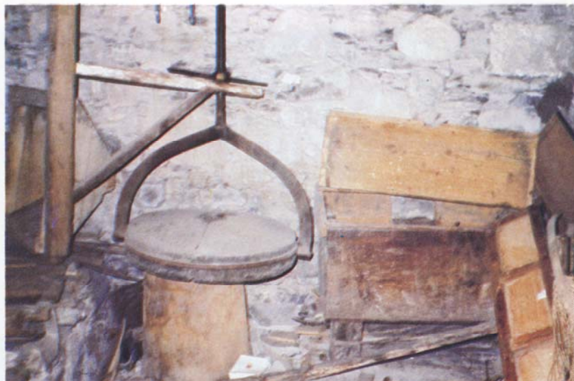
Molino de "Margarito", inactivo, en el Puente Viejo de Rosiana. 1.ª imagen.— Obsérvese: la caja del gofio a un lado del salón del molino y la piedra de arriba en posición de picado y abandonado en ese preciso momento. Imagen patética única en los molinos de Gran Canaria. Parece como si hubiera sido abandonado precipitadamente huyendo de algún cataclismo.
