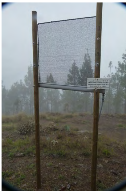
Ilustración 2; Standard Fog Colector (1 m 2 ) utilizado en la investigación básica en El Gaitero, Tenerife. (© Sánchez Megía, 2012)
