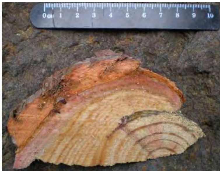
Figura 7; Cuña extraída del lateral de un descortezado donde se observa la cicatriz interna producida por la avenida y tapada por tejido calloso.
