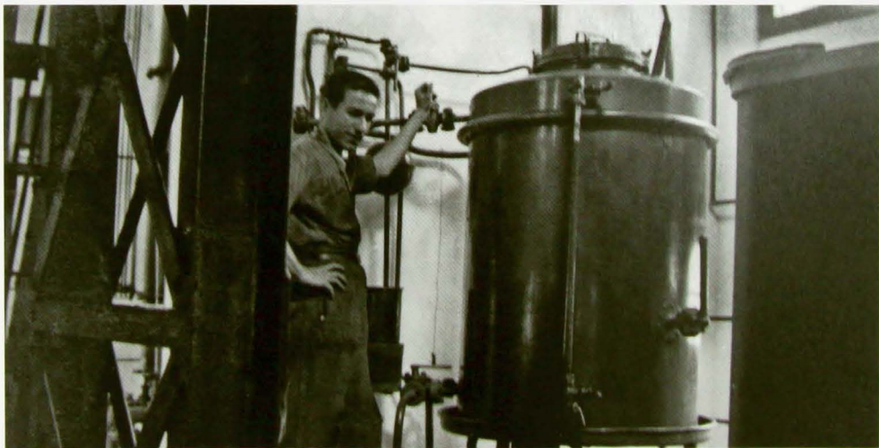
Autoclave para el tratamiento de la levadura, 1946 (atiende el proceso José Pérez). (Fondo documental de Destilerías Arehucas, S.A.).
