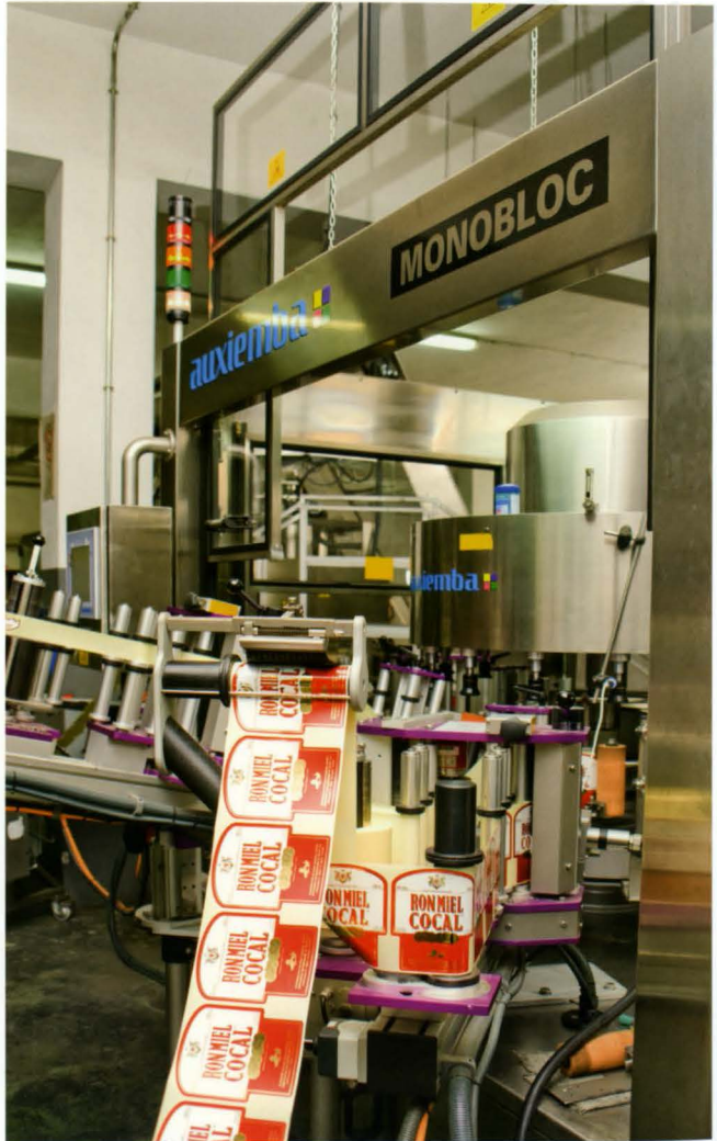
Etiquetadora de Tejina. (Fondo documental de Destilerías Arehuca S.A.).
