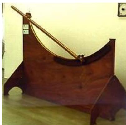
Figura 9. Comprobación experimental de la solución al problema de la braquistócrona.
