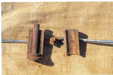
Foto 37. Molde para la fabricación de plomos.
