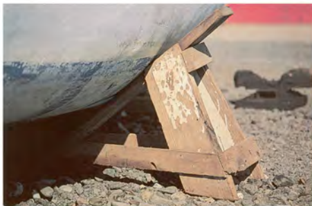
Foto 3. Burras de madera que mantienen la embarcación derecha.
