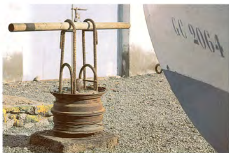
Foto 4. Virador manual utilizado para halar de la falúa desde la playa.
