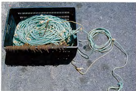
Foto 63. Cuando las nasas no se localizan en su lugar de calado, se utiliza este artilugio para rastrear el fondo y enganchar el cabo de unión de las mismas.
