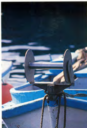
Foto 60. Roldana de proa por la que pasan los cabos durante el virado de las nasas.
