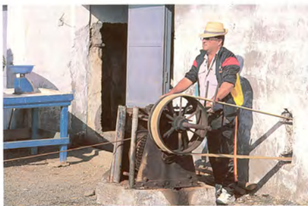
Foto 5. Mecanización de un halador (güinche) en Castillo del Romeral.
