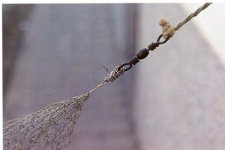
Foto 31. Detalle de la elaboración de una gueldera con bolsa de acero.
