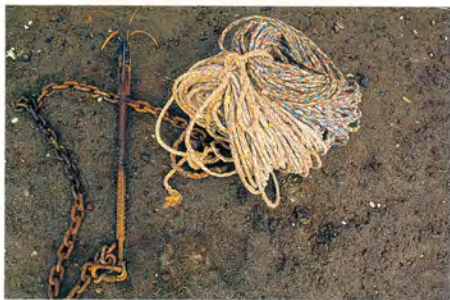
Foto 62. Grampín utilizado para recuperar las trampas enganchándolas por el cabo de unión de las mismas.
