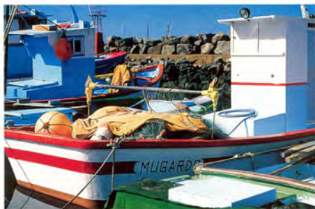
Foto 40. Barra horizontal en popa para evitar enredos durante la maniobra de calado del trasmallo.
