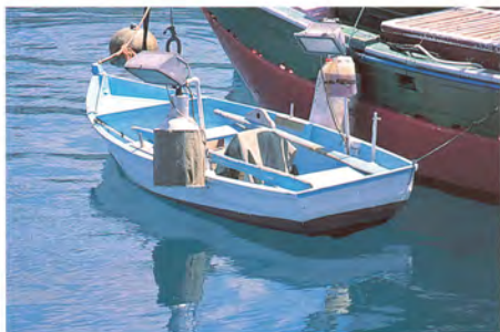
Foto 8. Barca auxiliar con focos para la atracción de pequeños pelágicos en la pesca con traíña.
