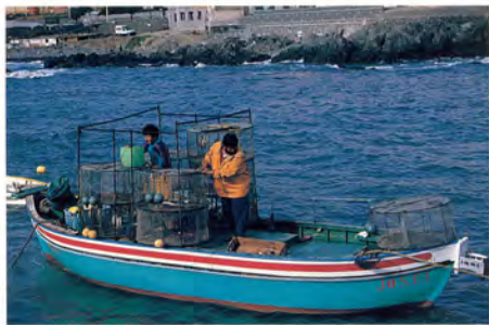
Foto 80. Estructura metálica para estibar las trampas en una falúa de San Cristóbal.
