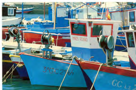
Foto 41. Maquinillas para el virado del trasmallo en embarcaciones del puerto de Arguenguín.
