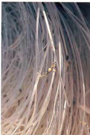
Foto 124. Liña madre de nailon de un palangre. Detalle de un giratorio al que se empata la brazolada.
