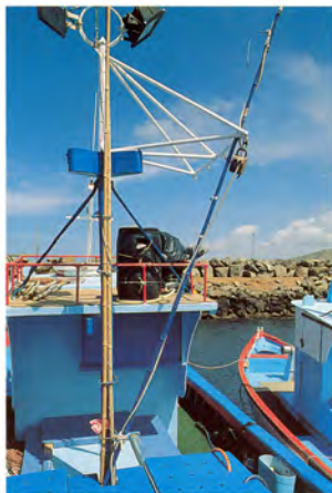
Foto 115. La horca permite la captura de grandes túnidos. En este caso el cabo pasa por la pluma de la embarcación.
