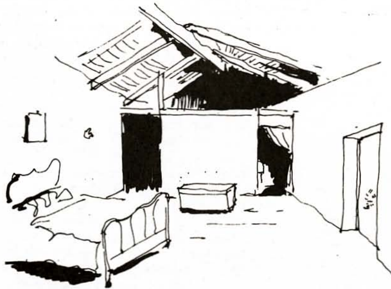
Compartimentación interior mediante tela de saco albeada y montada en un bastidor.
