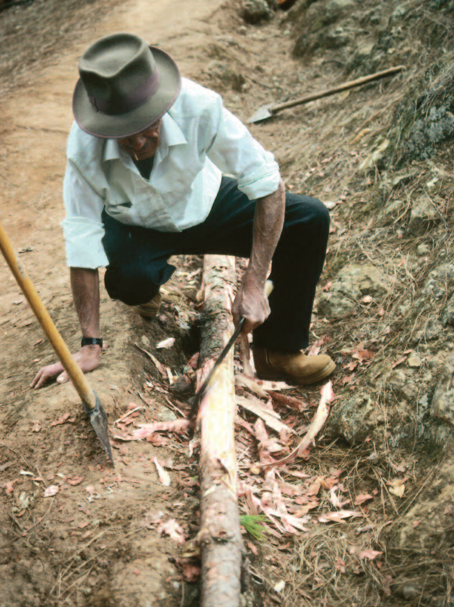
Descortezado tradicional con azuela.
