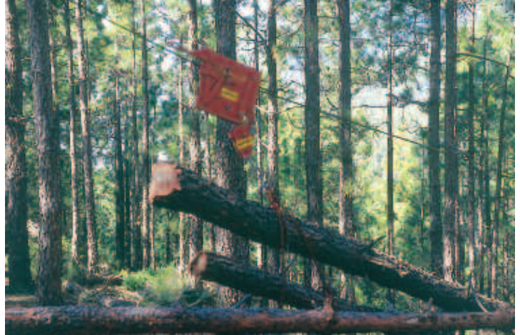
Teleférico forestal extrayendo fustes en monte de pino canario.
