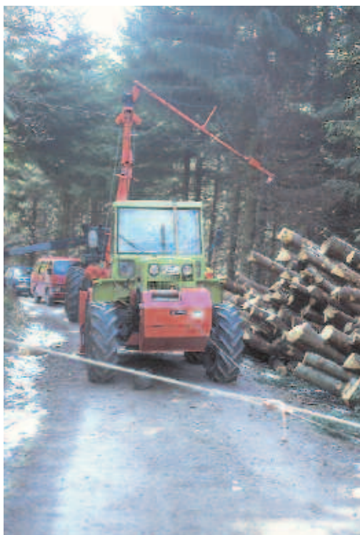
Teleférico forestal montado sobre tractor, en un monte joven de abeto, haya y picea (Wies-Selva Negra, Alemania).
