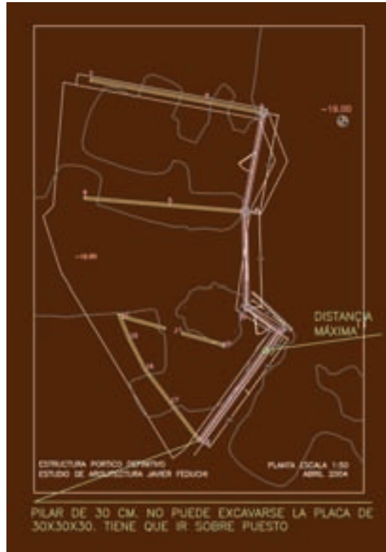
■ Figura 12. Pórtico soportante del forjado que sustituye a la antigua fachada.
