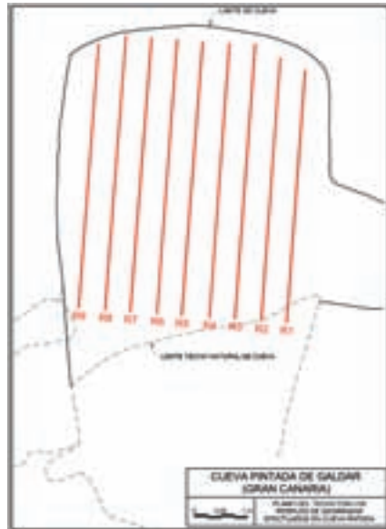
■ Figura 8. Planta de la cueva y localización de los perfiles de georrádar efectuados.
