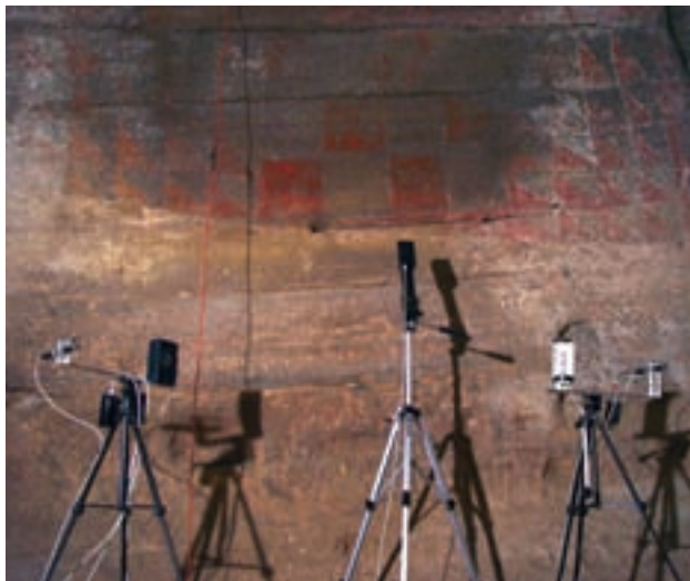
■ Foto 22. Sondas y equipos de medición de los parámetros microclimáticos instalados en el interior de la Cueva Pintada.
