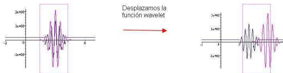
Figura 10. Desplazamos la ventana para comparar la señal (azul) con la función wavelet (magenta).
